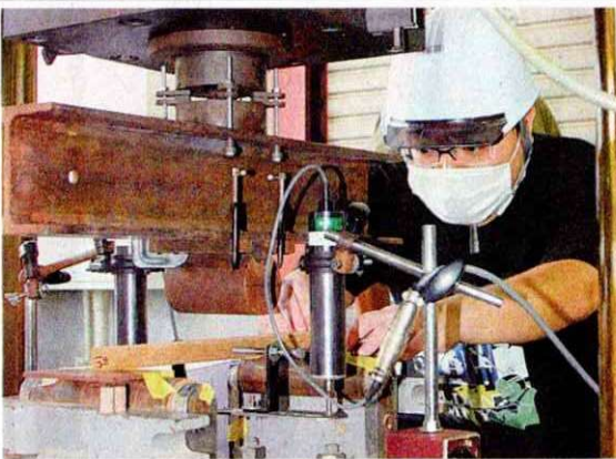
①オキナワウラジロガシが折れるまでのくらの力に耐えるかを測る試験でサンプルを機器にセットする琉球大学大学院2年の宮里貴大さん②正殿の梁の寸法に近づけた強度試験も予定しているカストロ教授③25日、西原町・琉球大学
