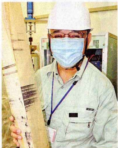
①オキナワウラジロガシが折れるまでのくらの力に耐えるかを測る試験でサンプルを機器にセットする琉球大学大学院2年の宮里貴大さん②正殿の梁の寸法に近づけた強度試験も予定しているカストロ教授③25日、西原町・琉球大学
