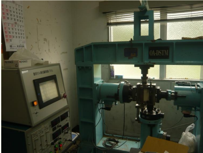
設置されたせん断試験機の状況
