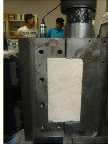
岩石供試体のせん断箱セット状況
