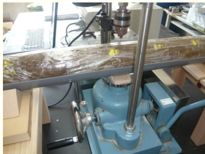
試験機による針貫入試験
