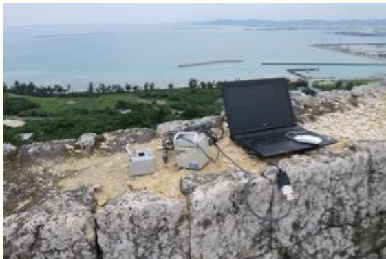
勝連城址における常時微動計測の様子
