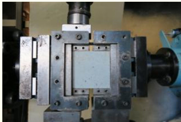
岩石供試体のせん断箱セット状況
