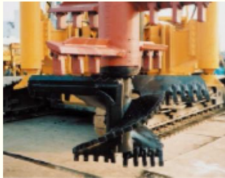
削孔・攪拌機
