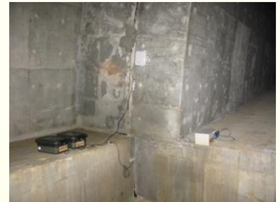
モニタリング：変位・AE・加速度
